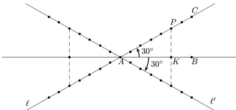
**Hipótesis:** El **L.G.** pedido consiste en dos rectas que resultan al girar - con centro de giro en  $A$  - la recta  $\overleftrightarrow{AB}$ , un ángulo de  $30^\circ$ . Si el giro es en el sentido horario se obtiene la recta  $l'$ , si es en el sentido antihorario se llega a la recta  $l$ .
