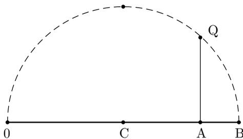
Con el compás construimos el semicírculo de centro  $C$  y radio  $\frac{a+b}{2}$ . Por el punto  $A$  levantamos la perpendicular a  $\overline{OB}$ , la cual corta al semicírculo en el punto  $Q$ . Veamos que la longitud del segmento  $\overline{AQ}$  es  $\sqrt{ab}$ .
