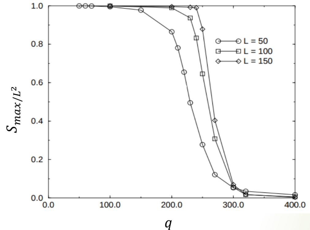
Comportamiento del dominio mas grande  $S_{max}$  entre el tamaño del sistema  $L^2$  vs  $q$  para tres diferentes tamaños del sistema con  $F = 10$
